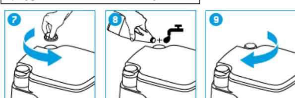
przygotowanie zbiornika na wodę
