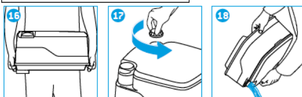
opróżnianie zbiornika na wodę
