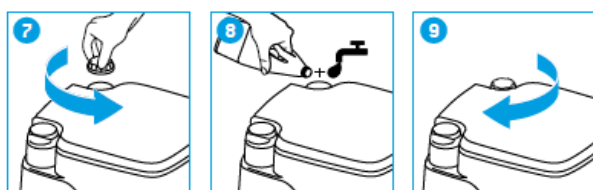
przygotowanie zbiornika na wodę
